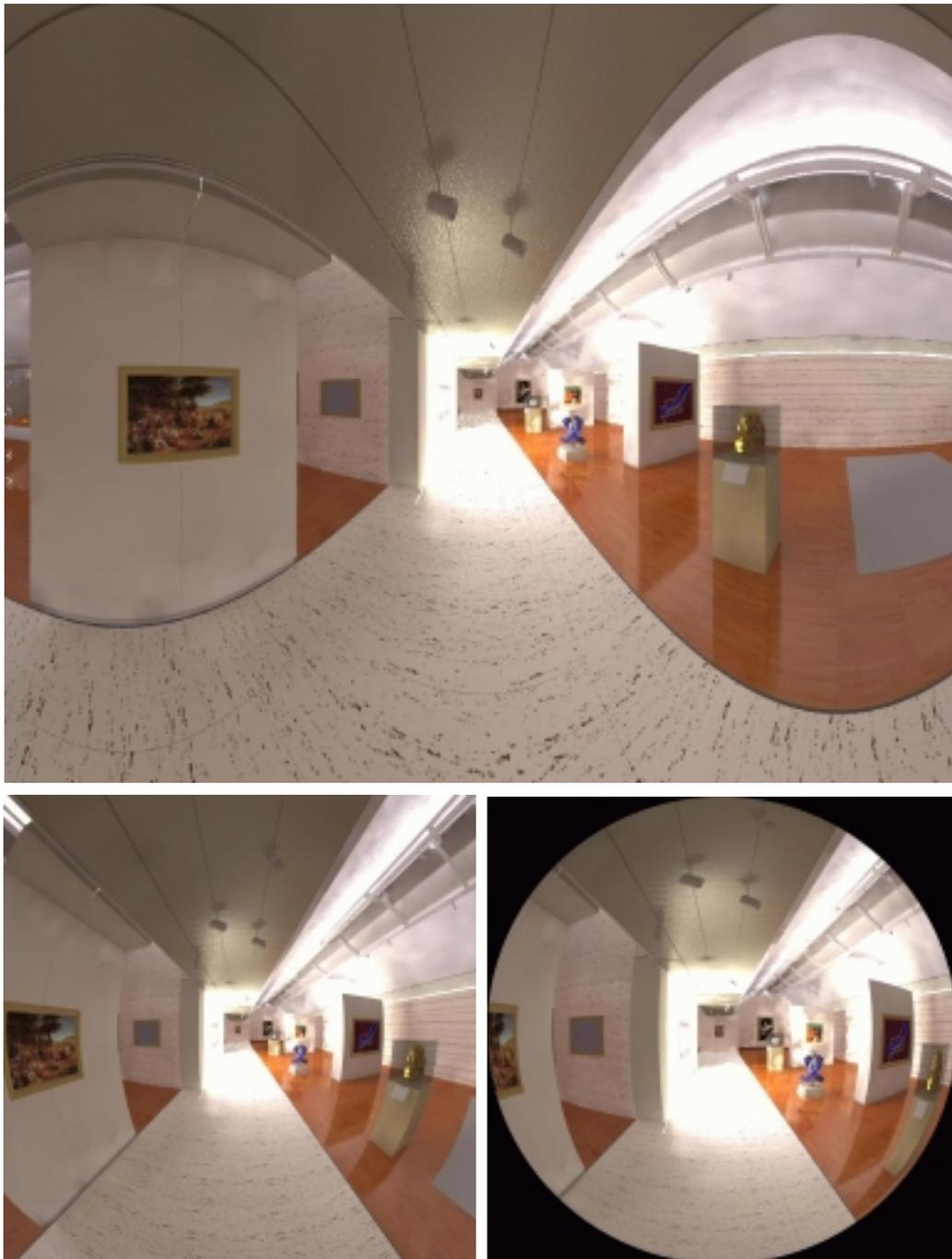
Abbildung 4.4: Verschiedene Projektionsarten eines Radiance Bilds vom gleichem Augenpunkt aus: (im Uhrzeigersinn: zylindrisch, lineares Fisheye, cos-Fisheye). Nicht hier dargestellt ist die Ansicht in Parallelprojektion.
