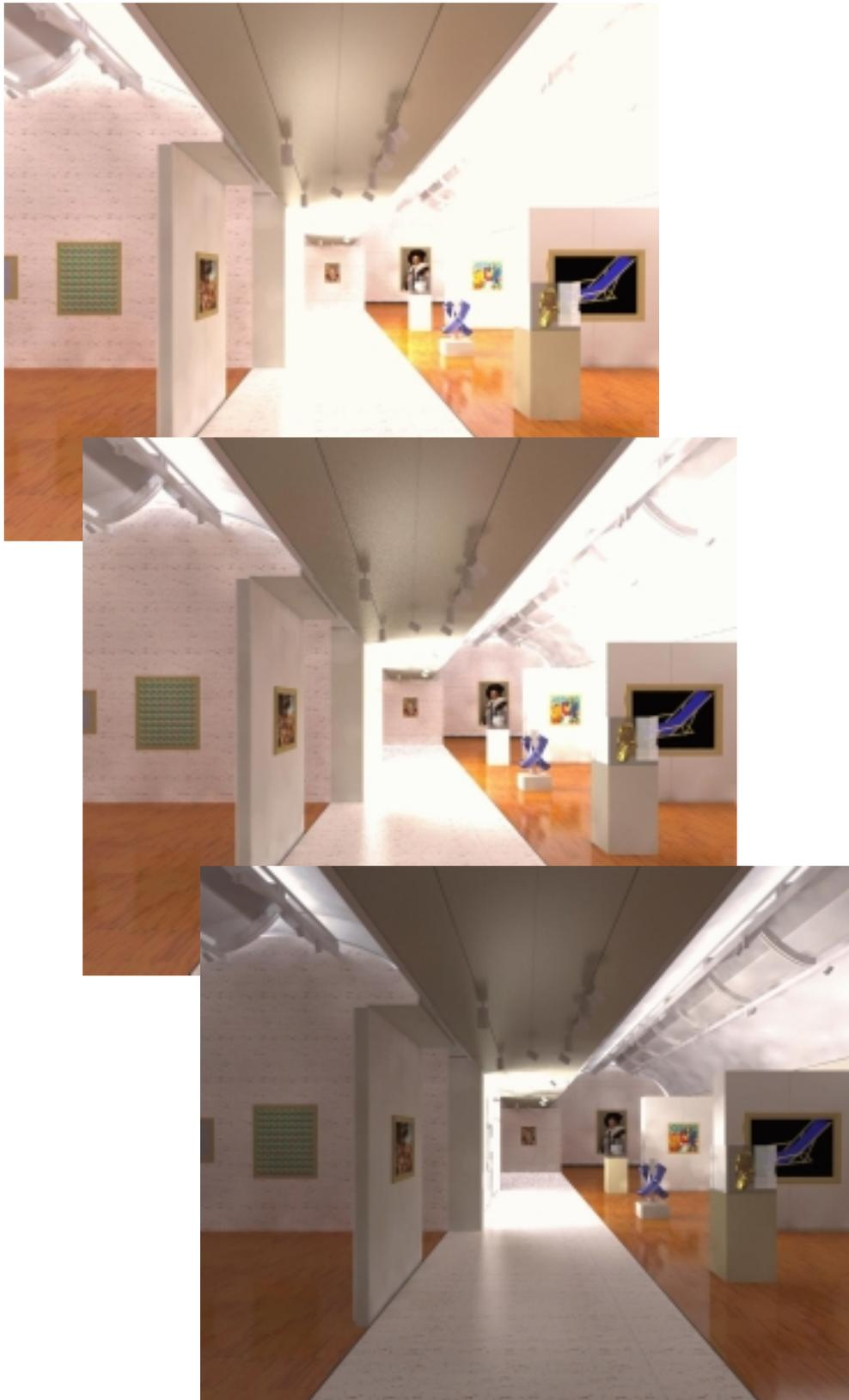
Abbildung 4.8: Die synthetische Blende in `pfilt` wirkt wie die Blende eines Photoapparats: Diesen drei Bildern liegen dieselben berechneten Daten der Leuchtdichte zu Grunde. Die Bilder entsprechen einer sog. Blendenreihe in der Photographie.
