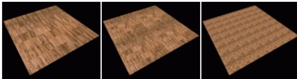
Abbildung 1.8: Beispiel der wiederholten Auflage eines Bildes auf einer Fläche (Texturierung): Links die ganze Fläche füllend, in der Mitte mit zweifacher Wiederholung in beiden Richtungen, rechts mit 8-facher Wiederholung. Bei Wiederholungen machen sich Grundmuster des Texturbilds stärker bemerkbar.
